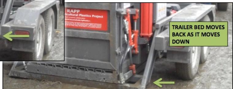
FIGURA 24. EL BASE DEL REMOLQUE BAJA.
