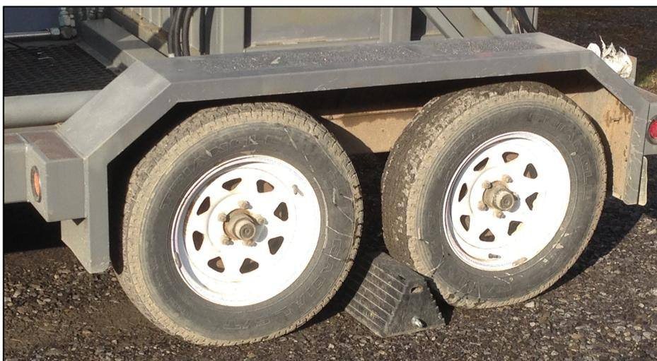
FIGURA 44. CUÑAS DE LLANTAS (WHEEL CHOCKS) ENTRE LAS RUEDAS DEL REMOLQUE, CADO LADO.
