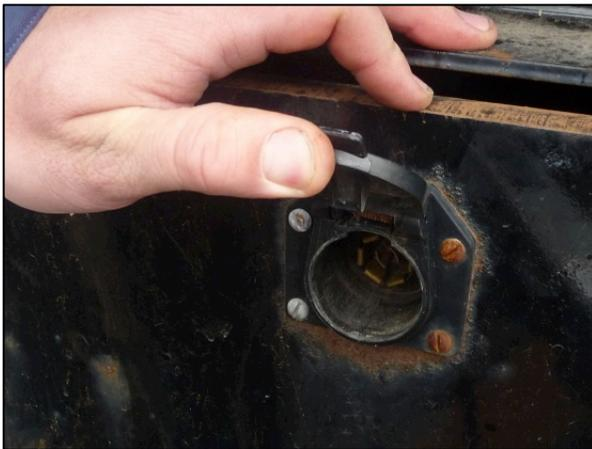
FIGURA 41. RECEPTÁCULO POR LA CONEXIÓN ELÉCTRICA DE 7 POLOS (TIPO RV).
