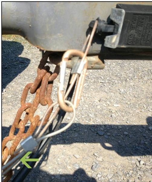
FIGURA 49. EL CABLE DE FRENO DE SEGURIDAD (BRAKE BREAKAWAY CABLE) PASA DESDE LA CAJA PEQUEÑA Y NEGRA VISTA EN LA DERECHA DE LA FOTO AL BUCLE RECEPTOR EN EL VEHÍCULO REMOLCADOR (FIGURA 43), ENTONCES AL CARABINA EN EL CENTRO DE LA FOTO.
