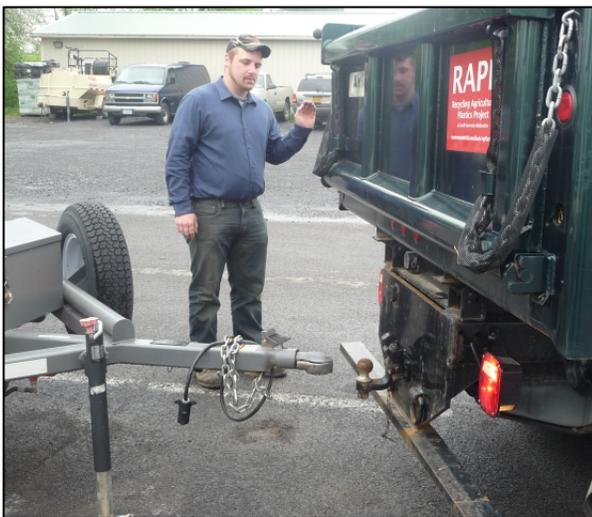
FIGURA 45. EL GUIA ASISTE EL CONDUCTOR DEL VEHÍCULO REMOLCADOR MOVER HACIA ATRÁS DE MODO QUE LA BOLA DEL CAMIÓN QUEDE DIRECTAMENTE BAJO EL ACOUPLE DEL REMOLQUE.
