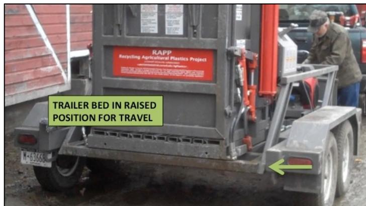
FIGURA 23. EL BASE DEL REMOLQUE ARRIBA.
