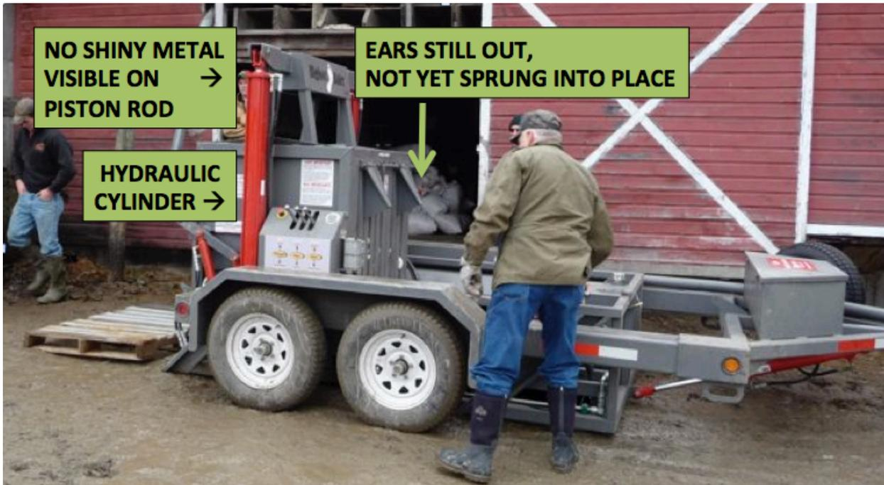
FIGURA 32. SIN METAL BRILLANTE A LA VISTA INDICA QUE EL PAQUETE NO ESTÁ SUFICIENTE LLENO
