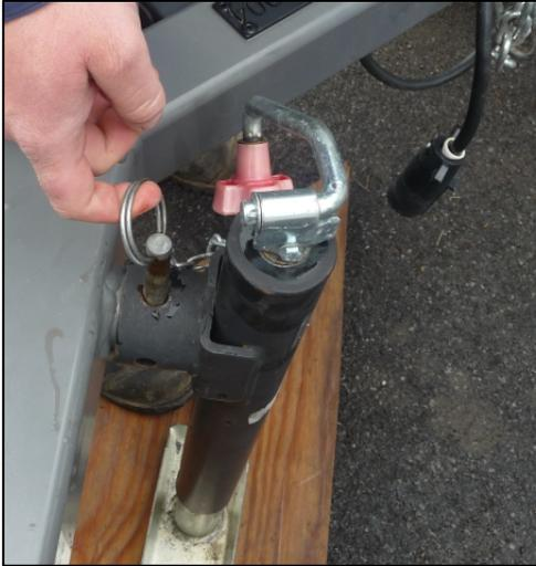
FIGURA 51. QUITA EL PESTILLO SUJETADOR DEL GATO (JACK RETAINING PIN) PARA QUE EL GATO PUEDA GIRAR A LA POSICIÓN HORIZONTAL.
