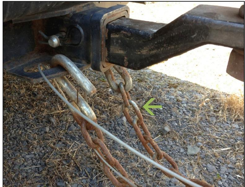
FIGURA 50. EL CABLE DE FRENO DE SEGURIDAD (BRAKE BREAKAWAY CABLE) PASA POR EL BUCLE RECEPTOR EN EL VEHÍCULO REMOLCADOR. LA FLECHA VERDE INDICA LAS CADENAS DE SEGURIDAD (SAFETY CHAINS) ENGANCHEN EN LOS BUCLES RECEPTORES (RECEPTOR LOOPS) DEL VEHÍCULO REMOLCADOR. A LA DERECHA DE LA FOTO, EL TIPO RECOMENDADO DE ENGANCHE DEL REMOLQUE CON BOLA DE 2-5/16", ELEVACIÓN DE 1" (RAISED BALL HITCH)
