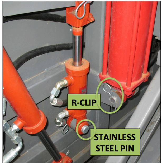
FIGURA 13. PESTILLOS Y SUJETADORES DEL REMOLQUE Y DE LA EMPACADORA.
