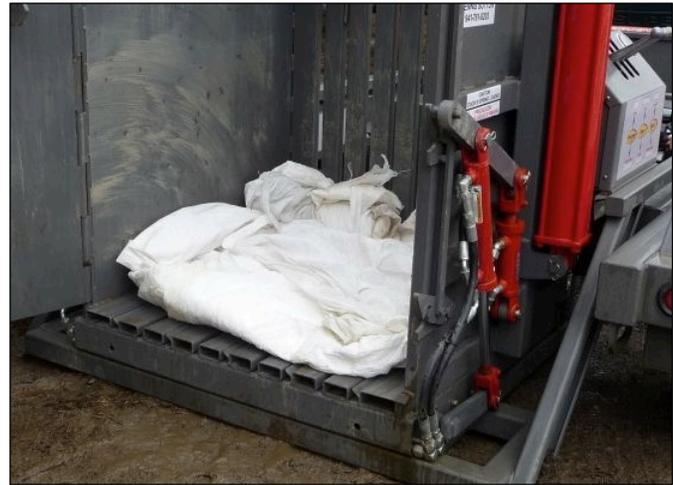
FIGURA 28. EVITE USAR EL ENVOLTORIO DEL PAQUETE COMO CAPA INFERIOR Y SUPERIOR.
