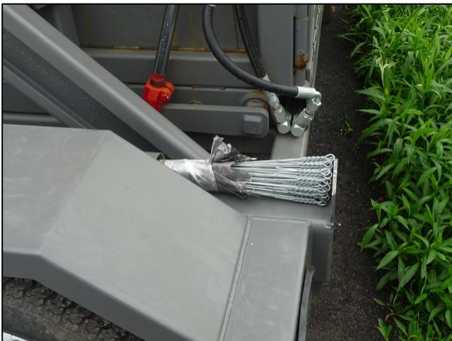
FIGURA 38. ROLLO DE ALAMBRES EN EL BASTIDOR DE ALAMBRES
