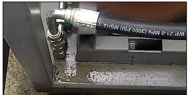
FIGURA 14. INDICACIÓN DE UN DESGASTE EN LAS MANGUERAS DEL SISTEMA HIDRÁULICO.
