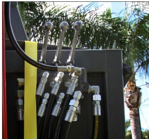
**OPERACIONES DE LA CAJA DE CONTROL** (FIGURA 7). La palanca de la izquierda controla la prensa. La palanca del medio controla cuándo se abren y se cierran los tres pestillos de la puerta (FIGURA 29). La palanca de la derecha controla los cuatro soportes en la base de la cámara de compactación. Cuando estos soportes se elevan, el paquete de plástico listo y embalado es expulsado (FIGURAS 30, 31).
