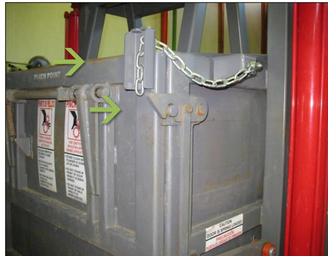
FIGURA 29. SISTEMA DE SEGURIDAD PARA EL PESTILLO DE LA PUERTA
