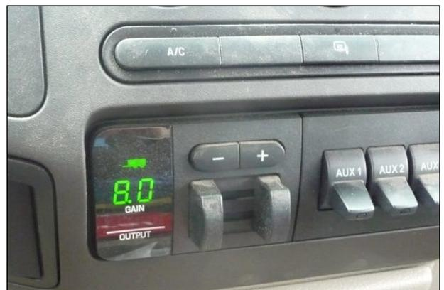
FIGURA 15. CONTROL DE LOS FRENOS DEL REMOLQUE (PARECE DIFERENTE EN VEHÍCULOS DIFERENTES).
