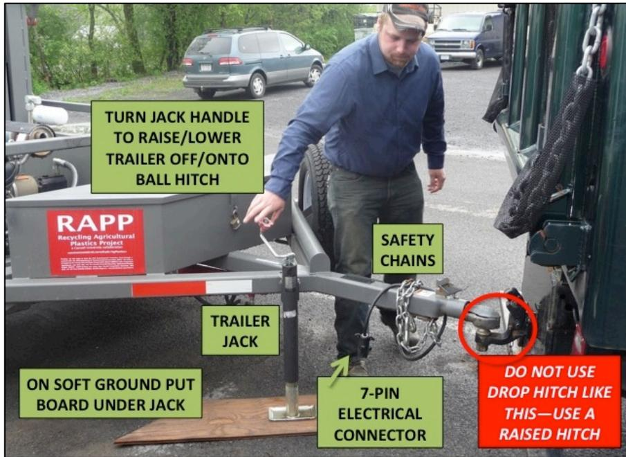
FIGURA 43. EL GATO DEL REMOLQUE (TRAILER JACK) DEBE ESTAR UBICADO PARA ESTABILIZAR LA LENGUA DEL REMOLQUE, CON UNA TABLA (BOARD) BAJO EL PIE DEL GATO SI EL SUELO ES BLANDO.
