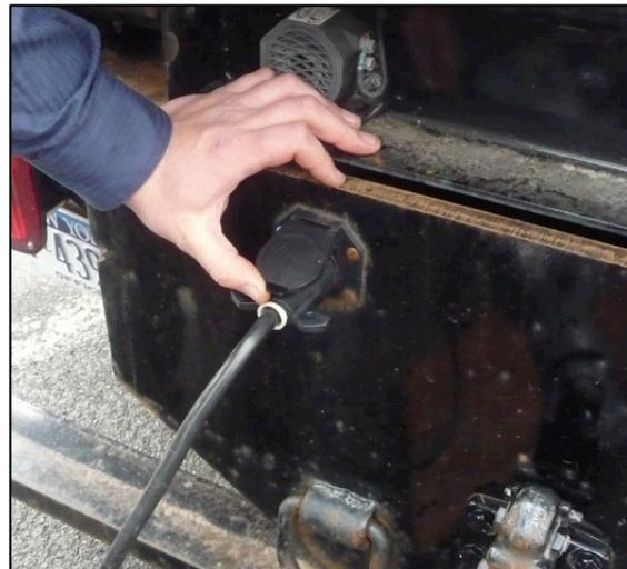
FIGURA 42. CONEXIÓN ELÉCTRICA DE 7 POLOS (TIPO RV).
