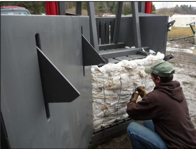
FIGURA 39F. ASEGURE LOS ALAMBRES PASANDO EL EXTREMO SIN BUCLE ALREDEDOR DEL AMARRE DOS VECES. LOS EXTREMOS SUELTOS NO DEBEN SALIRSE DEL PAQUETE. NO ANUDE EL ALAMBRE. EL ALAMBRE SE AJUSTARÁ CUANDO LA PRENSA SE SUBA Y EL PLÁSTICO SE EXPANDA.
