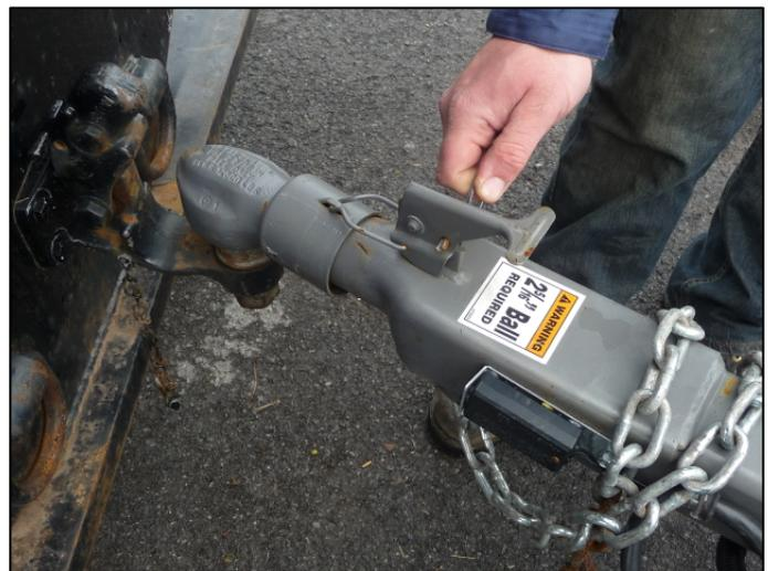
FIGURA 46. CIERRE EL ENGANCHE, INSERTANDO EL GANCHO DE SEGURIDAD EN LOS AGUJEROS DEL PESTILLO UBICADO EN LA LENGUA DEL REMOLQUE.
