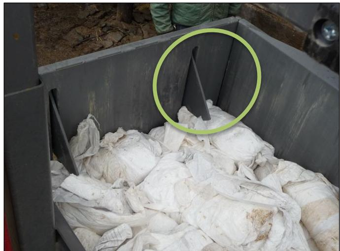
FIGURA 33. "OREJAS" DE LA EMPACADORA—DOS EN LA PUERTA Y DOS EN LA PARED POSTERIOR DEL COMPARTIMENTO—SE ACTIVAN PARA EVITAR QUE EL PLÁSTICO VUELVA A SUBIR.
