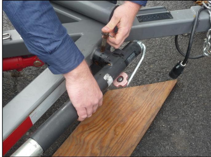
FIGURA 52. GIRE EL GATO A LA POSICIÓN HORIZONTAL Y FÍJELO CON EL GANCHO DE SEGURIDAD EN LA MONTURA DEL GATO. ENTONCES USE EL PESTILLO SUJETADOR DEL GATO
