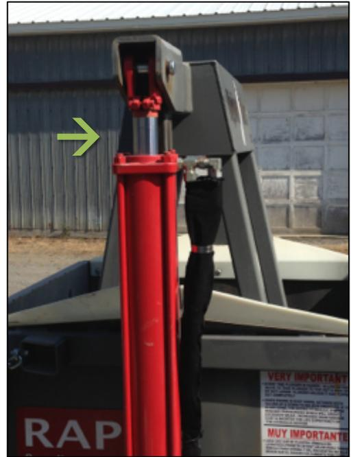
FIGURA 36. 2-3" DE METAL BRILLANTE VISTA EN LAS BARRAS DE LA PRESA.
