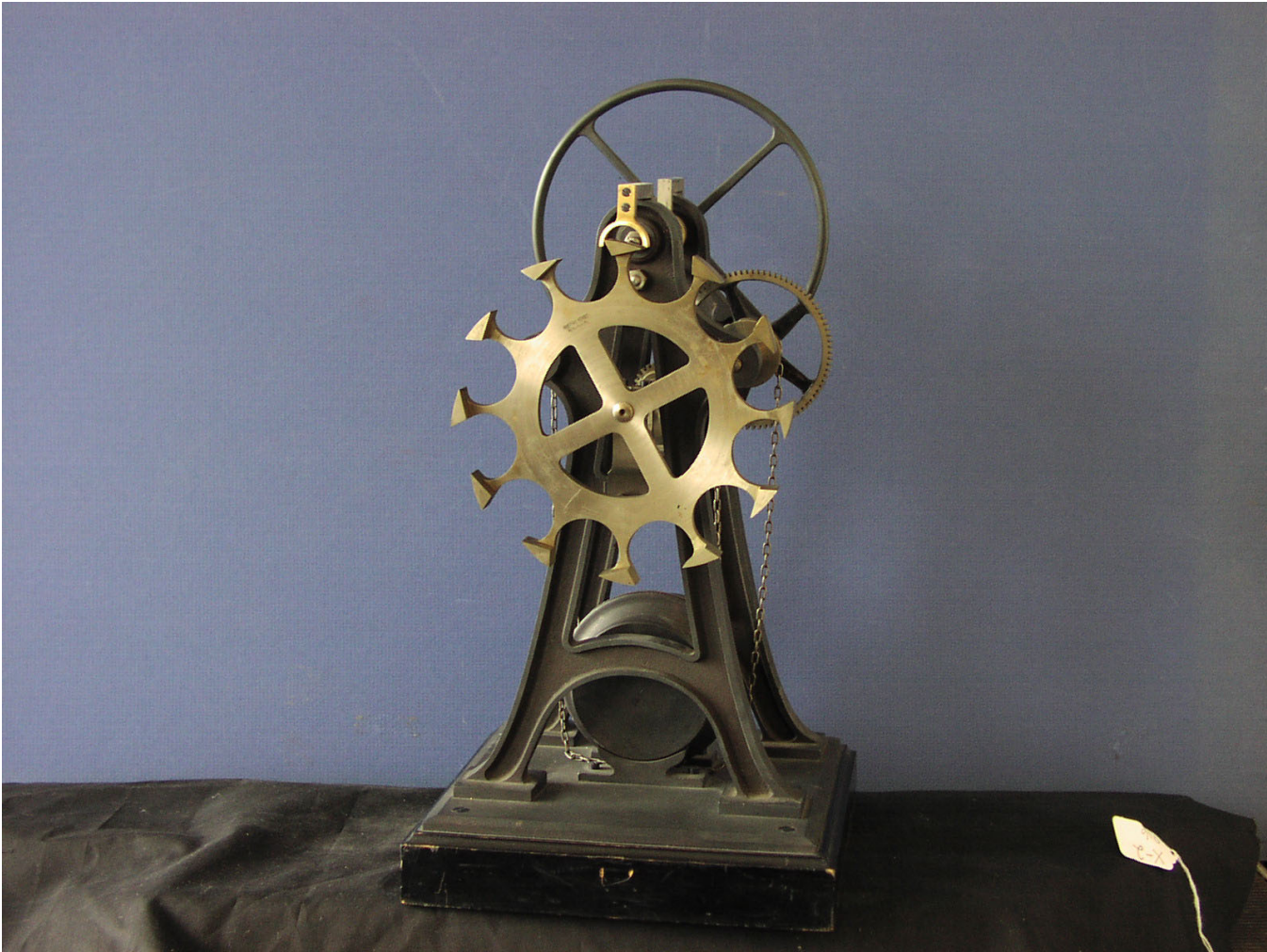
15. Cylinder escapement. Model X2, Voigt Catalog, Cornell Reuleaux Collection.
